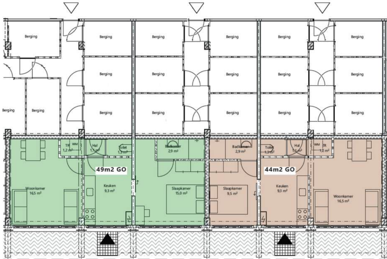
Voorbeeld van een stuk begane grond, met aan de ene kant de bergingen en aan de andere kant de nieuwe benedenwoningen.
