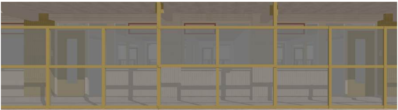
Aanzicht kozijnen galerijzijde, achter de nieuwe galerijhekken.
